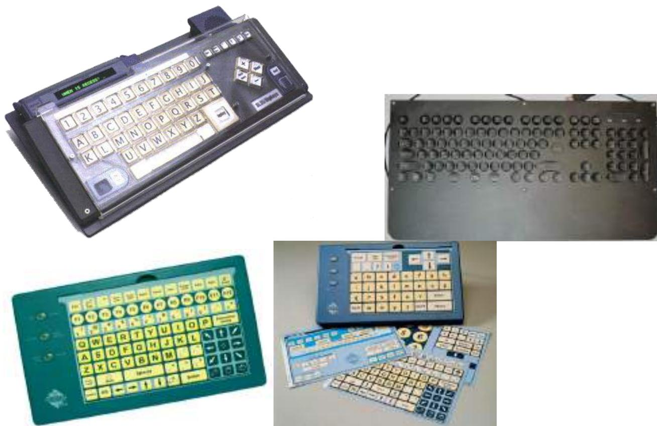
**Илл. 1.2-16. Специальная клавиатура для людей с тремором пальцев с увеличенным размером клавиш и жесткой пластиковой накладкой на клавиатуру; клавиатура с накладкой (для лиц с ДЦП) с металлической пластиной с отверстиями напротив кнопок, позволяющей зафиксировать пальцы в нужном положении; программируемая клавиатура с шаблонами и возможностью создавать их самому пользователю; сменные панели для программируемой клавиатуры**
