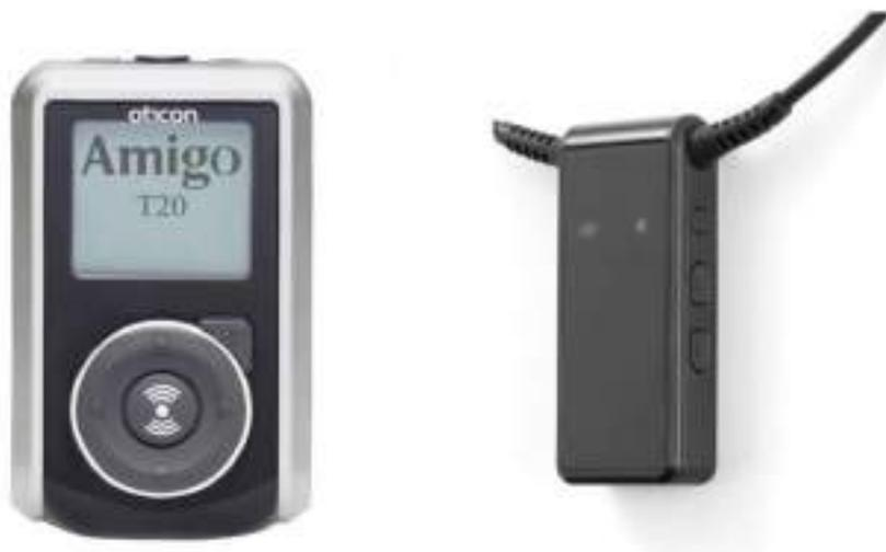
Илл. 1.4-3. FM-передатчик; FM-приемник.
