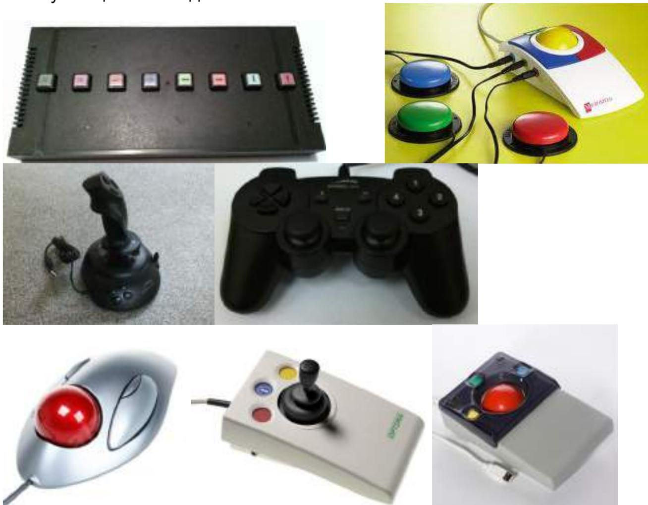
**Илл. 1.2-21. Мышь кнопочная большая с 4-мя кнопками со стрелками, предназначенными для управления перемещением курсора; трекболы, которыми можно управлять рукой с неподвижными пальцами; мышка-джойстик; мышка с управлением двумя рычагами для ослабленных рук**
