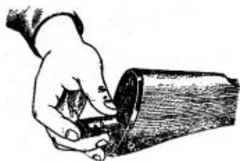
**Отделить у автомата дульный тормоз-компенсатор.** Утопить отверткой фиксатор дульного тормоза-компенсатора. Свернуть дульный тормоз-компенсатор с резьбового выступа основания мушки (со ствола), вращая его против хода часовой стрелки.
