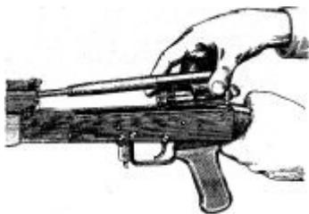
**Отделить затвор от затворной рамы.** Взять затворную раму в левую руку затвором кверху; правой рукой отвести затвор назад, повернуть его так, чтобы ведущий выступ затвора вышел из фигурного выреза затворной рамы, и вывести затвор вперед.
