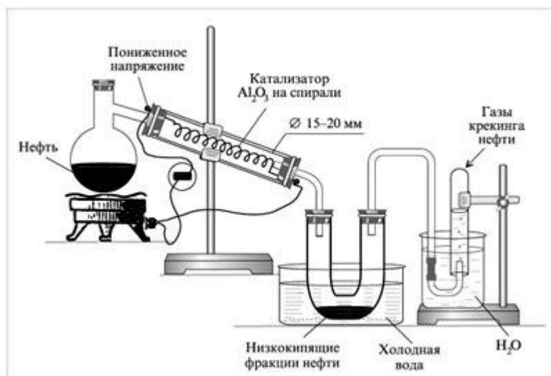
Схема получения в лабораторных условиях жидких и газообразных продуктов перегонки нефти (установка И.Т.Сыроежкина)
