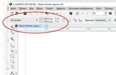
2. Разметить информационное поле с помощью направляющих: 20 мм. по контуру баннера от наружных краев – контрольное поле для компенсации смещения при печати и закреплении баннера.
